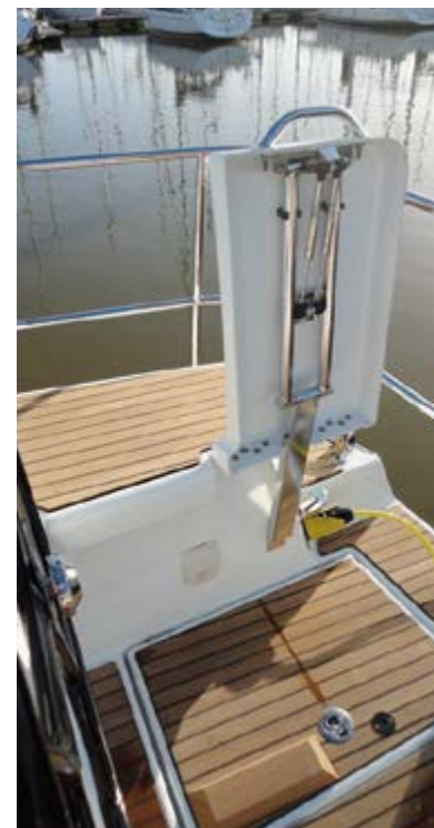
Dedicated liferaft locker with easy deployment / Coffre à BIB dédié avec mise à l'eau facile
