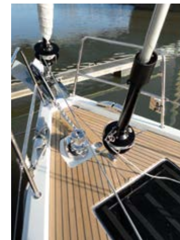
Dedicated liferaft locker with easy deployment / Coffre à BIB dédié avec mise à l'eau facile
